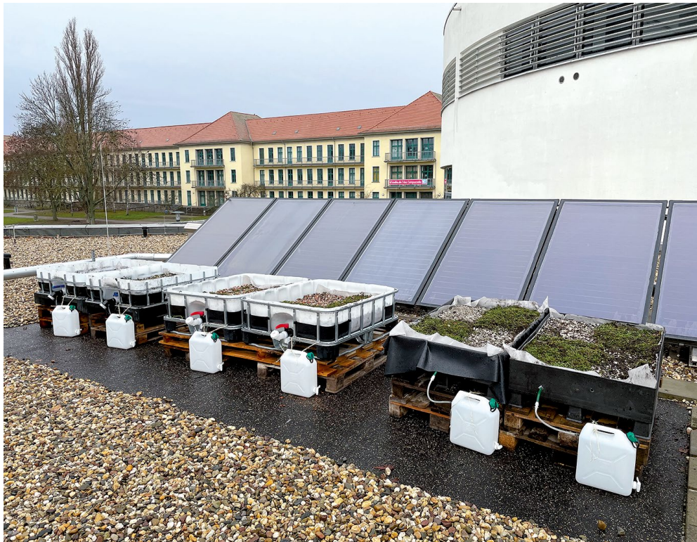
Bild 1: Lysimeter-Versuchsfläche auf dem Dach der Hochschule Magdeburg-Stendal
