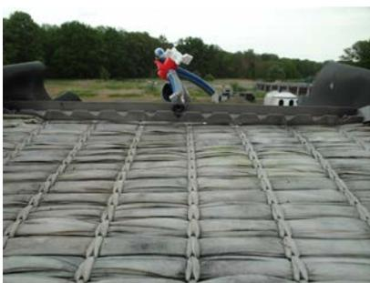
Set-up: punktuelle Beschickung beider Matten (à 2 m<sup>2</sup>) mit vorgereinigtem Abwasser: 15 L/(m<sup>2</sup>\*d), Schlauchpumpe, Intervall (alle 2 Stunden für 5 min mit einer Durchflussrate von 0,5 L/min), 10.5. bis 1.11.2022 & ab 15.5.2023 bis dato
