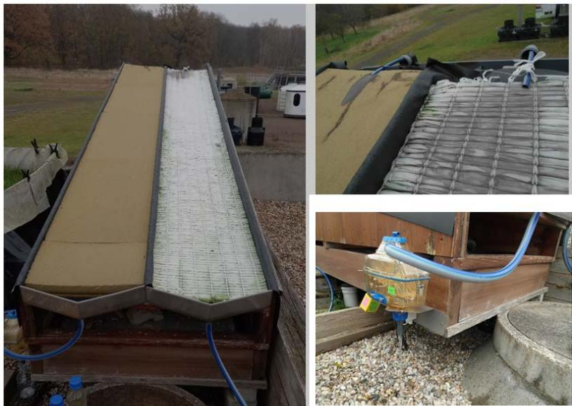
Abb. 1: Dachsegment zur Untersuchung der Reinigungsleistung von Wasserretentionsmatten (*links*), Zufluss im oberen Bereich der Matte (*rechts oben*), Kippzähler zur Erfassung der Menge des abfließenden Wassers (*rechts unten*).
