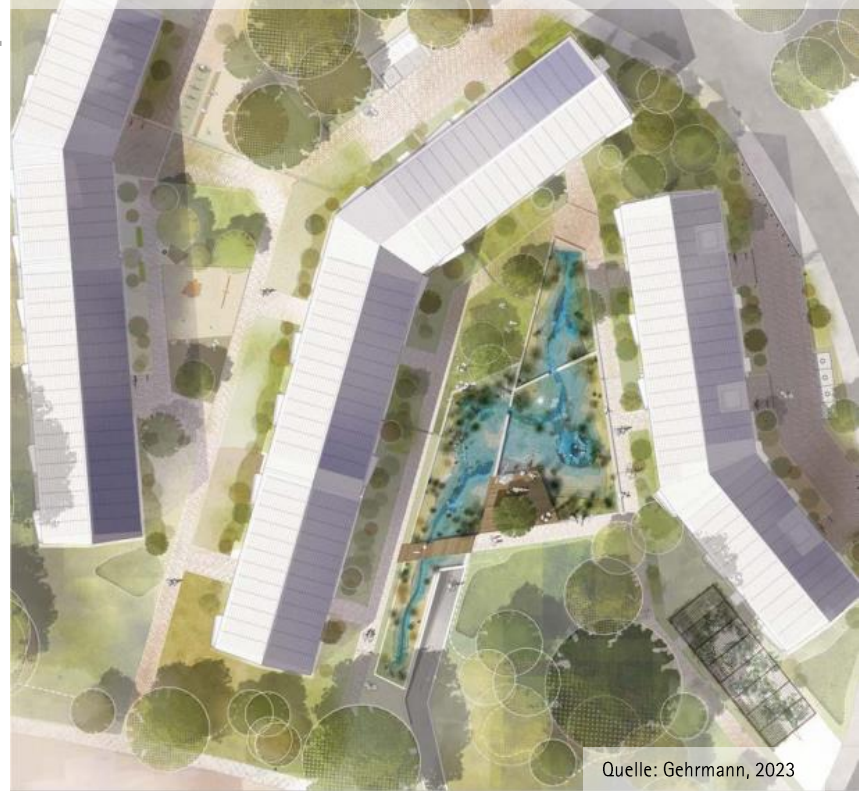
Wasser in Außenanlage bei Regen + Servicewasserbetrieb
